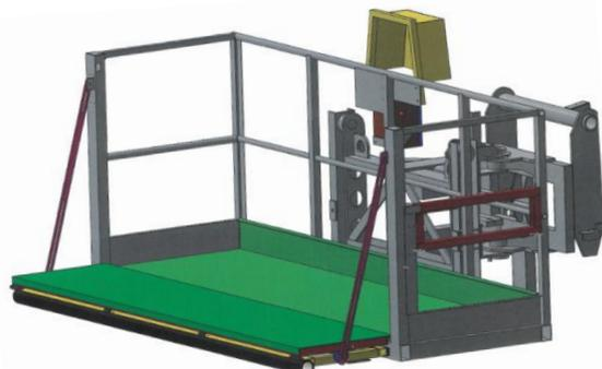
Mit diesem Arbeitskorb und dem eingebautem Sicherheitssystem ist es für maximal 2 Personen, über gesicherten PSaGA erlaubt, den Arbeitskorb über die Frontausstiegstüre zu verlassen.
